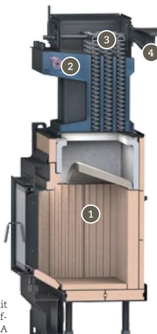
Grundofentür 51/67 mit Grundofenbrennraum 66x42 und aufgesetztem Grundofen-Kessel GOK A
